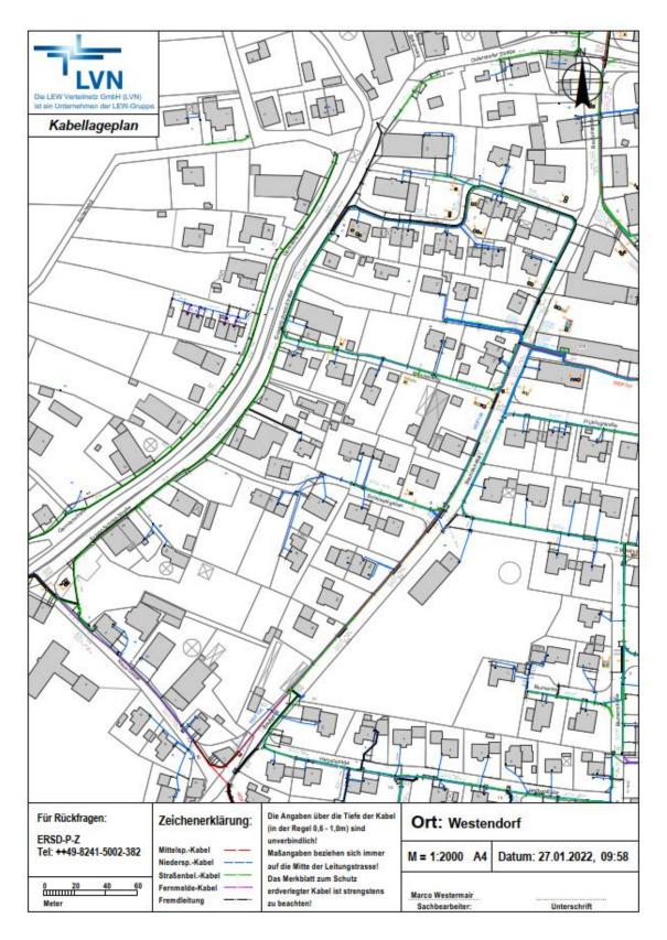
Abbildung 7: Kabellageplan o.M., Stand 27.01.2022 (Quelle. LEW Verteilnetz GmbH (LVN)
